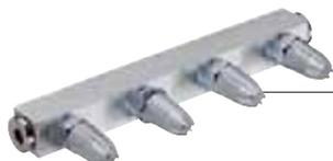
El SILVENT 304 L consta de 4 boquillas de soplado 209 L. Cono de soplado de 240 mm (9.45") a una distancia de soplado de 150 mm (6"). Potencia de soplado, 14.0 N (49.4 oz). Longitud, 197 mm (7.76").
